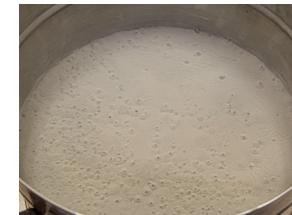
Trous / canaux d'air dans la surface fluidisée
