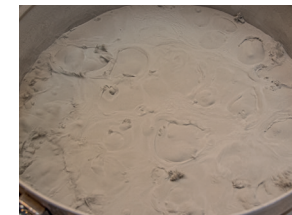
Formation de bulles dans le réservoir de fluide
