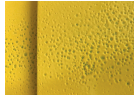
Défauts de mouillage dus à une adhérence insuffisante de la poudre
