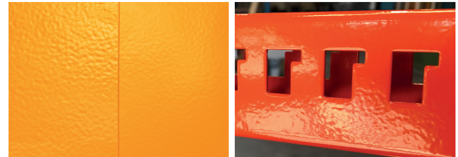
Zu hohe Schichtstärke kann zu Orangenhaut führen
