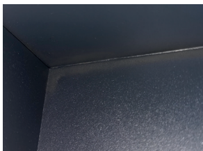
Unzureichende Schichtstärke in Innenkanten
